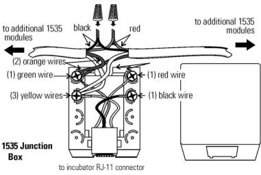
Figure 6-2. RS485 Wiring
